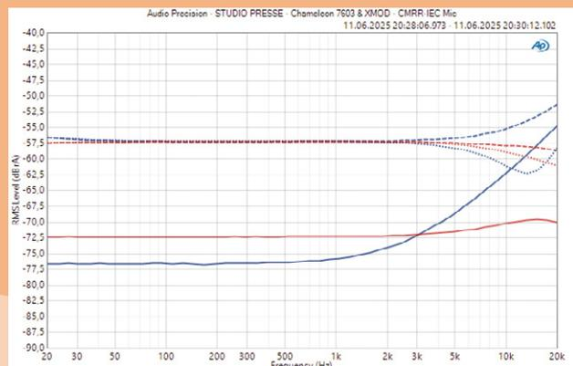
Diagramm 8: Gleichtaktunterdrückung CMRR 7603 (rot) und 7603 XMOD (blau), oberste Messung stellt das gute Ergebnis dar
